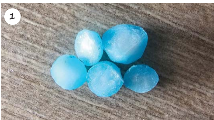
Deursnit van KynoPlus se urease-gestabiliseerde korrels wat die "deurweekte blou voorkoms" duidelik in die binneste gedeeltes van die korrels aantoon (foto-erkenning aan J Sparrow).
